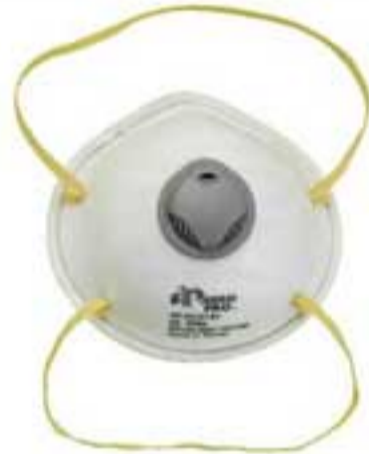
DC01BV 防塵口罩 符合 EN149 FFP1 標準 可調式鼻樑夾，彈性頭帶 具排氣閥提高呼吸舒適度
