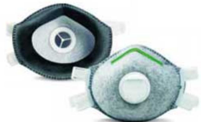
SPERIAN P1135-1 防金屬燻煙口罩 • 符合美國 NIOSH P95 標準。 • 含活性炭層，可防禦臭味及有機蒸氣、無毒微粒、金屬燻煙。 • 單向排氣閥提高呼吸舒適度和延長使用時間。 • 頭帶採四點單項可調式設計。
